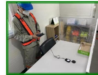
ภาพถ่ายการตรวจวัดแสงสว่างในสถานที่ทำงาน บริเวณ ใต้ทำงาน (จุดเองอาจ น.)
